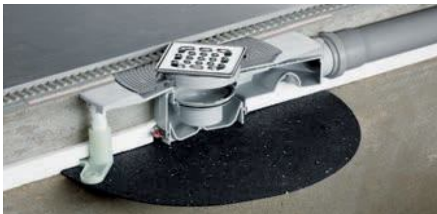
Сифонът Advantix Top със защита срещу хидравличен срив чрез бариера с воден затвор с разположен в среда проходен отвор и странични джобове.
